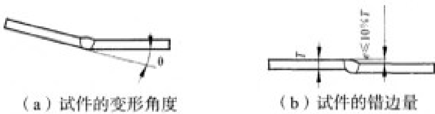
图 A-4 板材试件的变形角度和错边量
